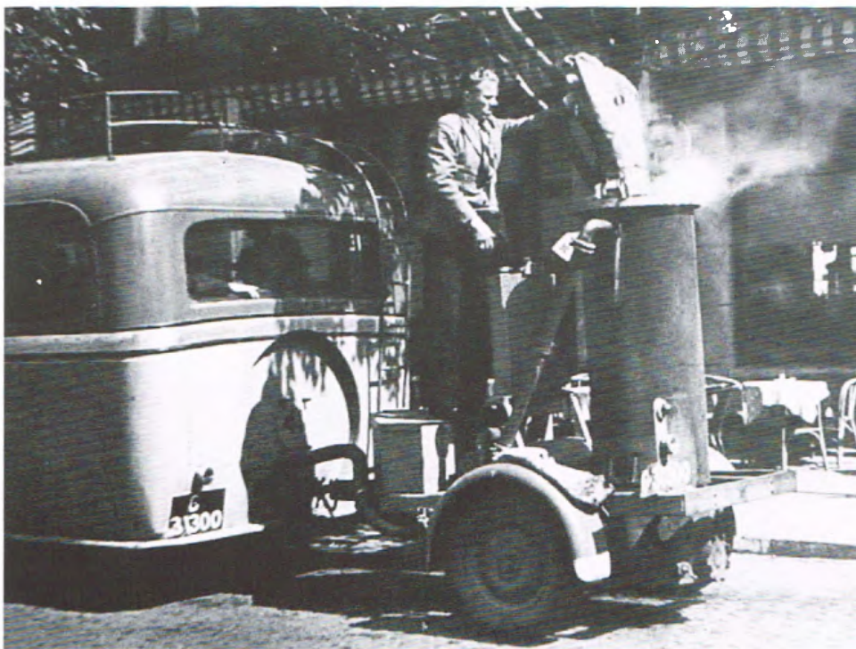
Deze autobus was al uitgerust met een houtgas-generator, toen de benzine niet meer leverbaar was.
